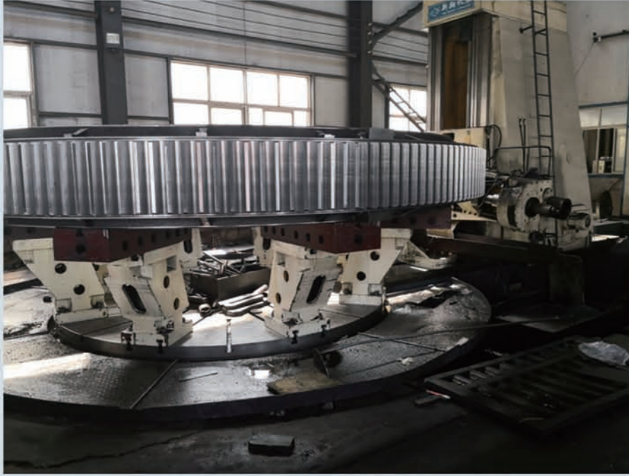
数控滚齿机 球磨机大齿圈加工 CNC gear hobbing machine ball mill gear ring machining
